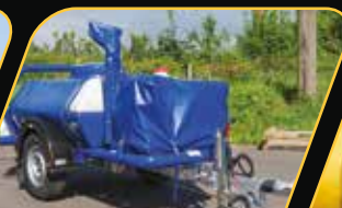
3. HOUSSE DE PROTECTION Housse de protection contre les intempéries pour protéger le moteur
