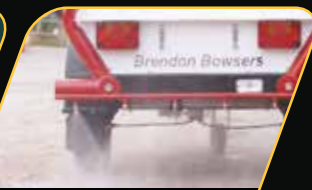
8. RAMPE DE PULVERISATION Rampe de pulvérisation arrière à 6 buses pour la suppression des poussières.
