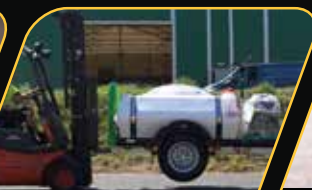
7. POINTS DE LEVAGE POUR FOURCHE Points d'ancrage arrière pour fourche de chariot élévateur pour une mobilité accrue.
